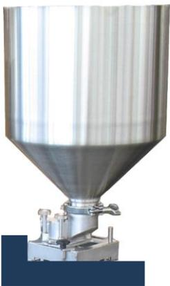
Die Edelstahl Füllmassenbehälter können mit Hilfe des Schnellverschlusses schnell gewechselt werden. Auf diese Weise ist das Wechseln der zu verarbeitenden Füllmasse sehr einfach. Auch zähflüssige Füllungen können verarbeitet werden. Die robuste Konstruktion der Pumpe ist in der Lage, diese ohne Verstopfung zu fördern.
